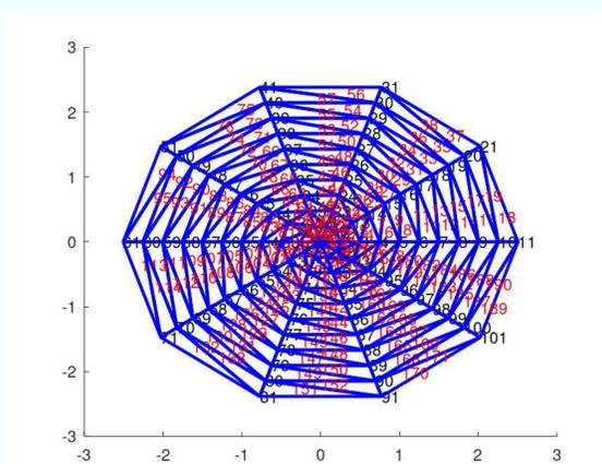
Figura 3: Malla de un dominio circular y su triangulación  $\tau_h$ .
