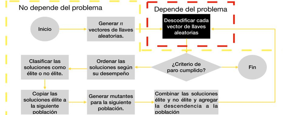
Figura 02. Estructura de un BRKGA.
